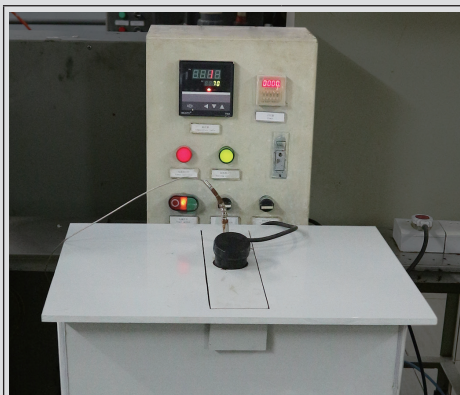
Bain de test à l'hypochlorite de soude
