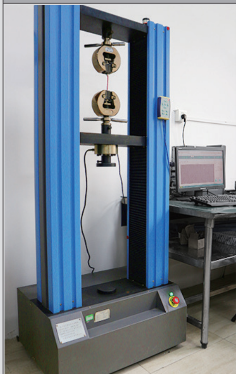
Machine d'essai de force d'arrachement
