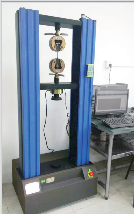
Equipement de mesure de l'élongation à la rupture
