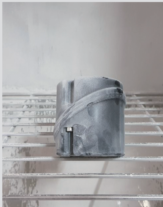
Boitier en cours d'essai IP6x
