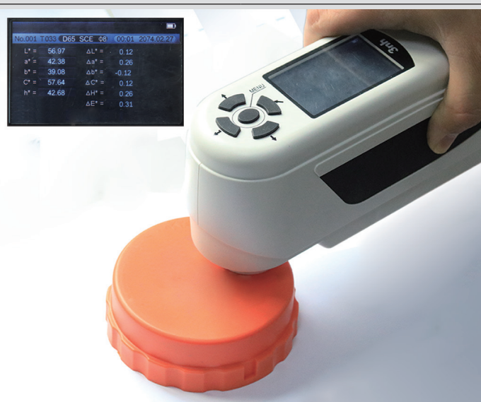
Mesure du \Delta E sur un couvercle de boîtier
