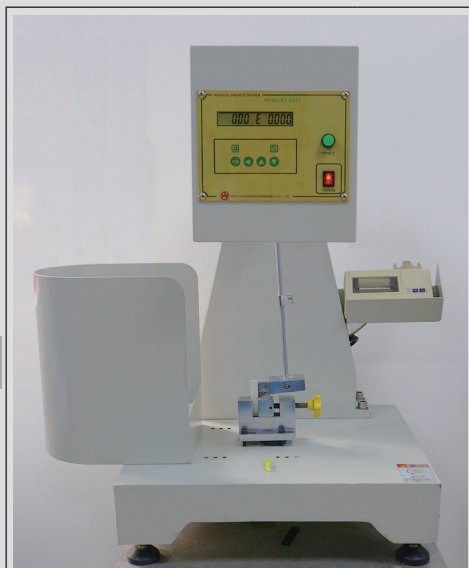
Machine d'essai Charpy
