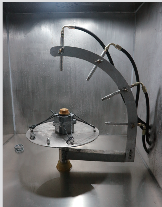
Boitier en cours d'essai IPx9K
